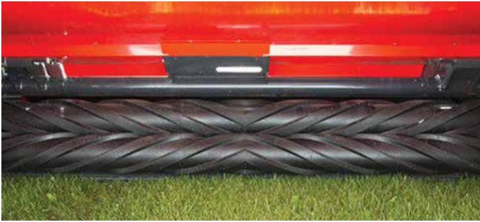
Conditionneur à tapis ou vis (regroupement fourrage) sur faucheuse conditionneuse
